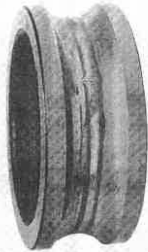
شکل ۱-۵ اولین ترک‌های ناشی از خشبستگی بر روی رینگ داخلی یک بلبیرینگ شیار عمیق
