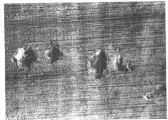
شکل ۲۰-۵ حفره‌های ایجاد شده در رینگ یک رولربیرینگ استوانه‌ای به دلیل جرقه‌های حاصل از عبور جریان الکتریکی از بیرینگ
