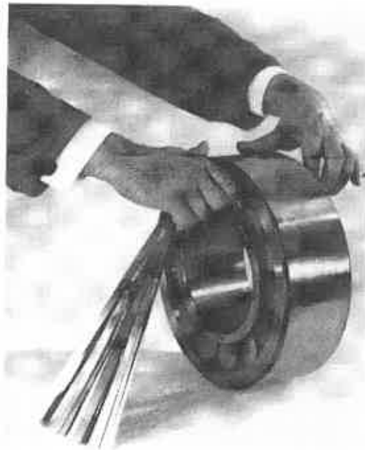
شکل ۴-۶۱ کنترل لقی شعاعی G_r در زولر بیرینگ‌های کروی
