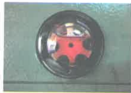
مکان نصب چشمی (روغن‌نما) های کنترل اندازه روغن، - چشمی روغن جعبه دنده اصلی در پشت دستگاه قرار دارد.
